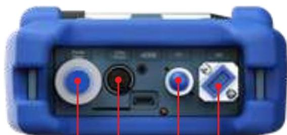
Interface OTDR MM/SM /source lumineuse
